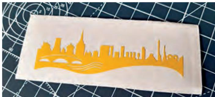
sie beim Ablösen kaputt gehen könnte, klebt man zum besseren Handling eine sogenannte Transferfolie darüber. Mit samt der durchsichtigen Transferfolie kann man den erstellten Aufkleber nun ablösen und auf sein Wunschobjekt aufkleben. Nach dem Andrücken wird die Transferfolie wieder vorsichtig abgelöst und zurück bleibt das fertige, selbst erstellte Ergebnis.
