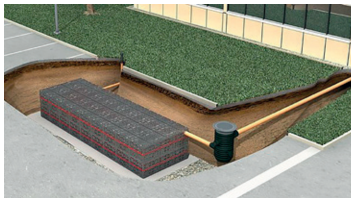
Rigolen-System des Herstellers Graf (Quelle: Otto Graf)
